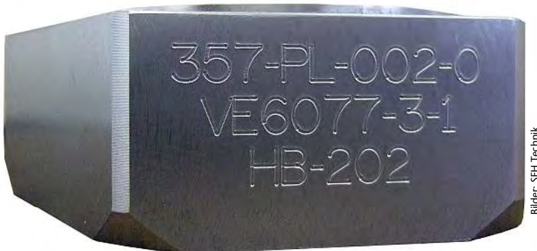
Bild 4: Die oszillierende Beschriftungsnadel setzt immer einen Punkt neben den anderen.
