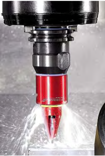
Bild 1 (links): Die Beschriftungsnadel wird über die Werkzeug-Innenkühlung der Bearbeitungsmaschine angetrieben.
