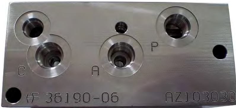
Bild 3: Die Beschriftung des Ventilblocks erfolgt in der Bearbeitungsmaschine.
