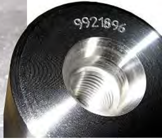
Bild 2 (unten): Welle mit stirnseitiger individueller Teilenummer, beschriftet auf einem Drehautomaten.
