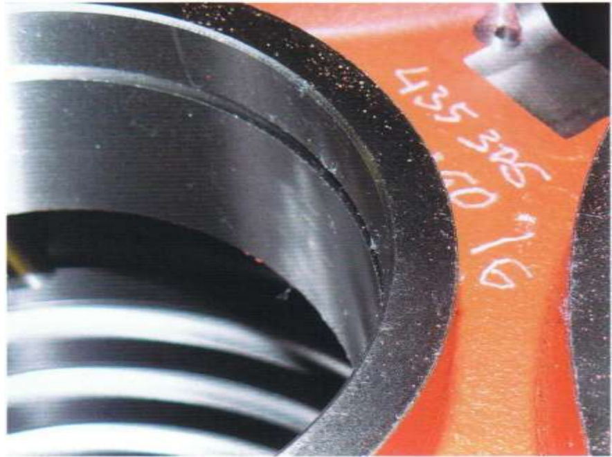
Bild 2: Speziell das automatisierte Entgraten bringt neben der Zeiteinsparung, mehr Arbeitssicherheit und reproduzierbare Qualität
